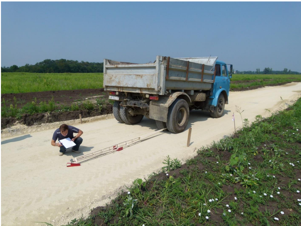
Рисунок 1 – процедура измерения прогиба дорожной одежды.
