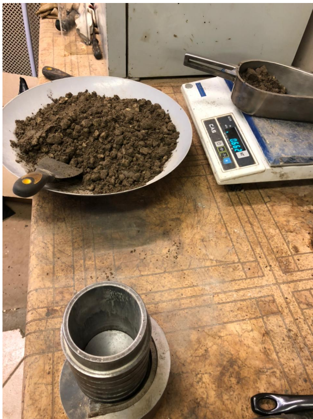
Приготовление обработанного грунта
