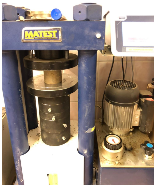
Испытание на прочность при сжатии
