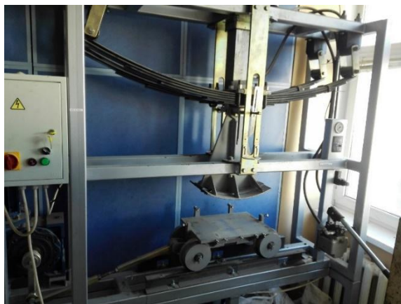
Рисунок 5 – Секторный (вальцовый) уплотнитель
