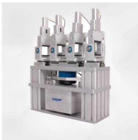
Рисунок 6 – Испытательная установка, определяющая усталостные свойства асфальтобетона
